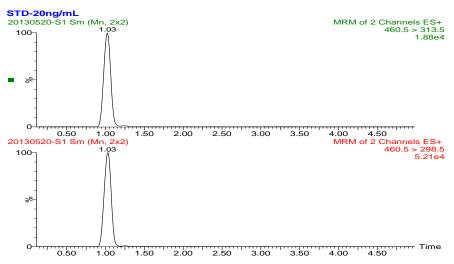
图 A. 1 氮氨菲啶基质匹配标准溶液特征离子质量色谱图( $20~\mu g/L$ )
